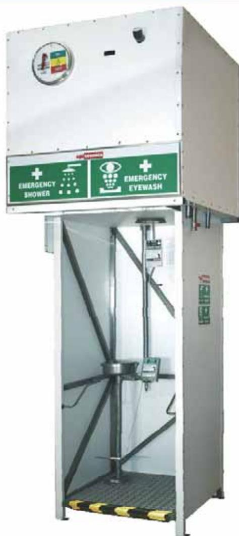
Está equipada con tanque de 1000 litros de polietileno calidad alimentaria, que garantiza un mínimo de 15 minutos de flujo de agua. Su funcionamiento es por gravedad.
